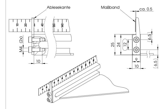
Um den Zeigefinger an dem Tiefenanschlag zu befestigen, müssen zwei Gewinde M4 geschnitten werden.
